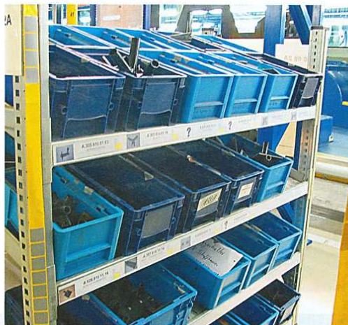
Bei Max Mothes ist ein Kanban-Liefersystem im Einsatz. Damit ist gesichert, dass die Produktion der Kunden bedarfsgerecht beliefert wird.
